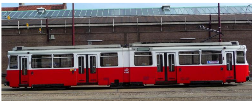
Rys. 1. Wagon typu E6, stanowiący bazę dla zmodernizowanych tramwajów EU8N
